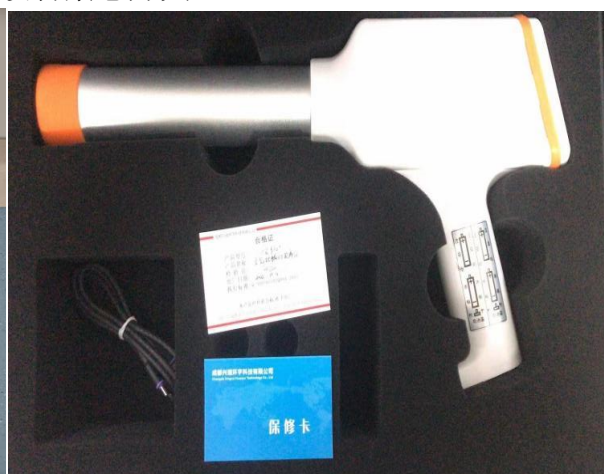
图3-5 辐射自检设备
